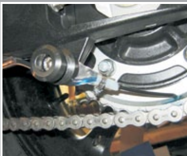
Montage de la buse de sortie et de la durite d'huile
