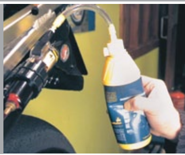
Éliminer les bulles d'air et purger l'air du flexible d'alimentation
