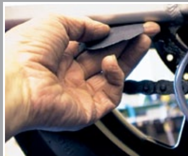
Nettoyage et dégraissage des surfaces
