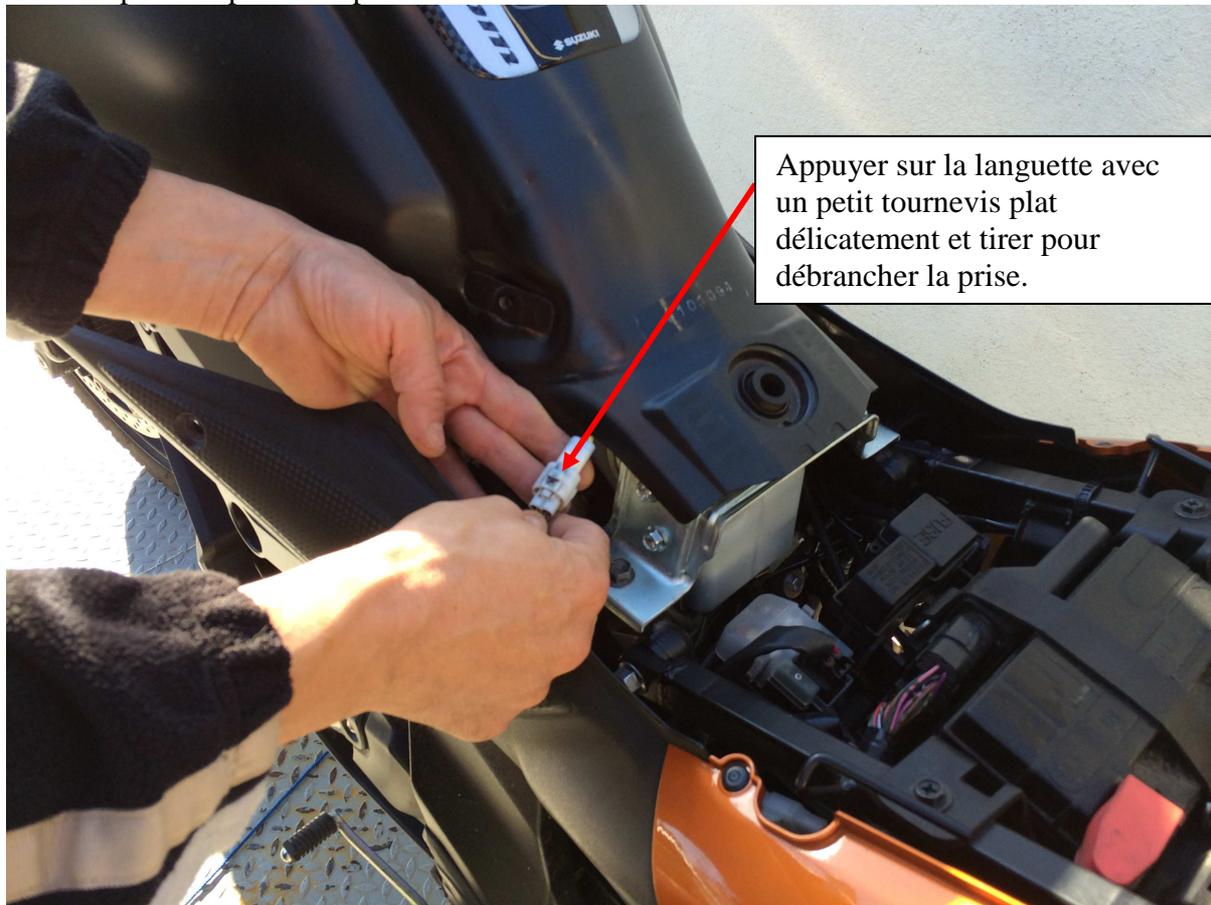
Appuyer sur la languette avec un petit tournevis plat délicatement et tirer pour débrancher la prise.
