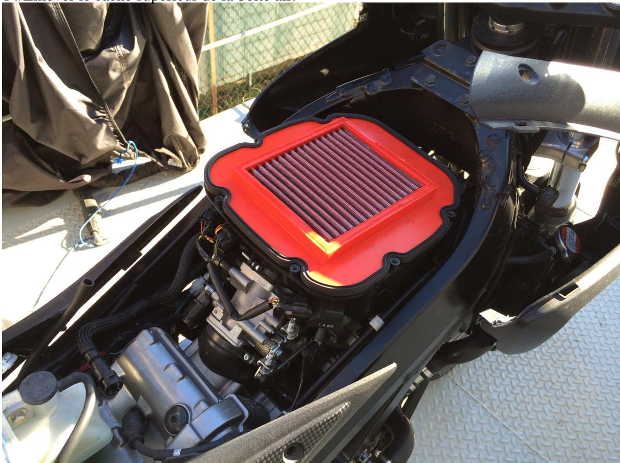
15/ Retirer le filtre et récupérer le joint car il n'est pas fourni.
