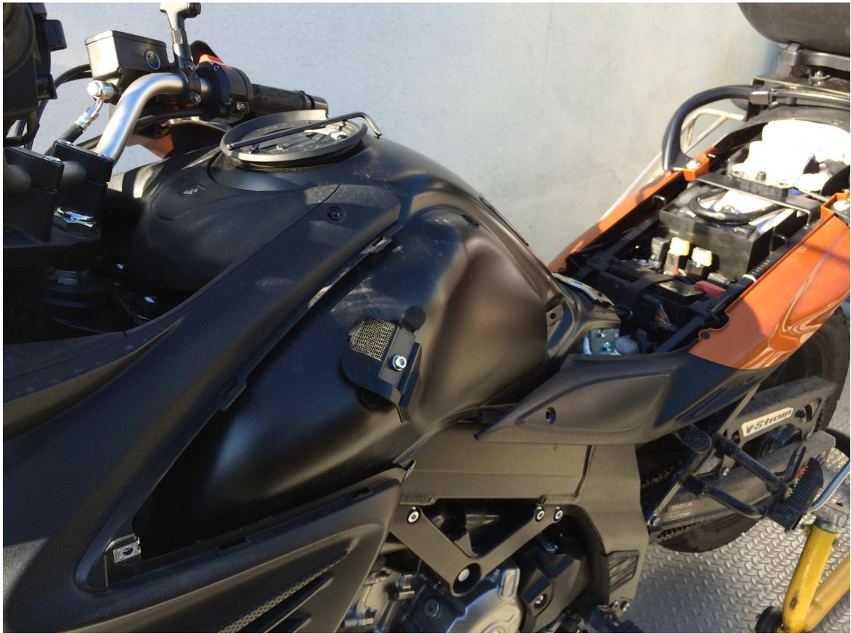
6/ Dépose du cache sup, retirer les deux vis
